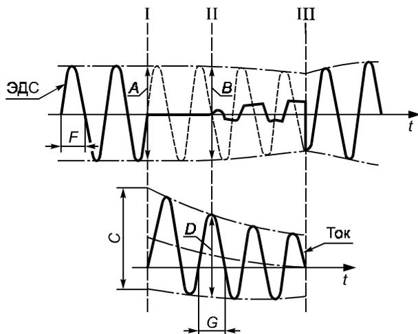
$$\text{Полное сопротивление контура } Z = \frac{E}{I_{\text{о.п}}} = \frac{B}{D} = \frac{A}{C} \cdot \frac{F}{G},$$
