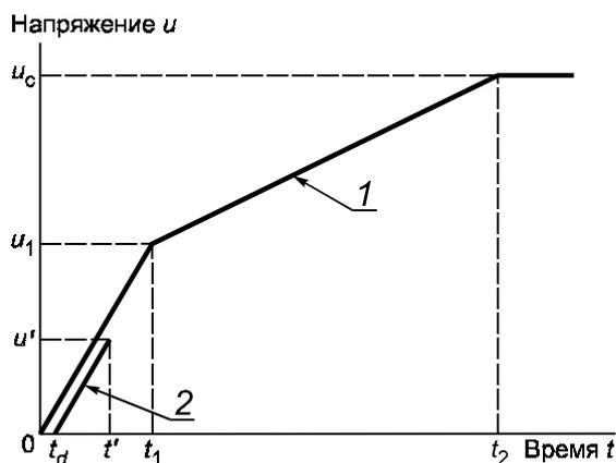
1 — условная граничная линия ПВН; 2 — линия запаздывания ПВН (параллельная граничной линии)
