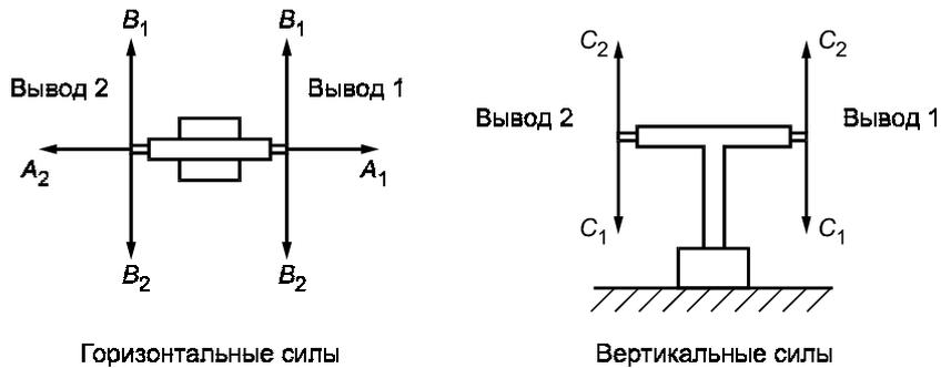
Горизонтальные силы  $F_{shA}$  и  $F_{shB}$  прикладываются в направлениях  $A_1$ ,  $B_1$  и  $B_2$  — для вывода 1 и в направлениях  $A_2$ ,  $B_1$  и  $B_2$  — для вывода 2.
