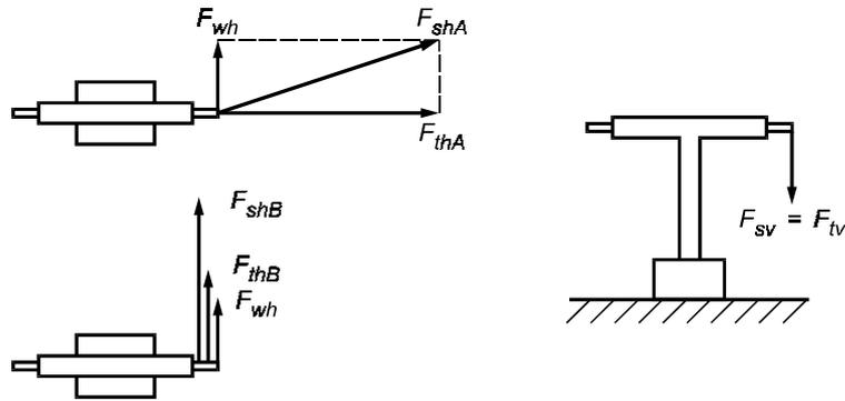
$F_{thA}$  — горизонтальная сила тяжения проводов (направление А);  $F_{thB}$  — горизонтальная сила тяжения проводов (направление В);  $F_{tv}$  — вертикальная сила тяжения проводов (направление С);  $F_{wh}$  — горизонтальная сила давления ветра на выключатель, покрытый льдом;  $F_{shA}$ ,  $F_{shB}$ ,  $F_{sv}$  — нормированная статическая нагрузка на выводы (резльтирующие силы)
