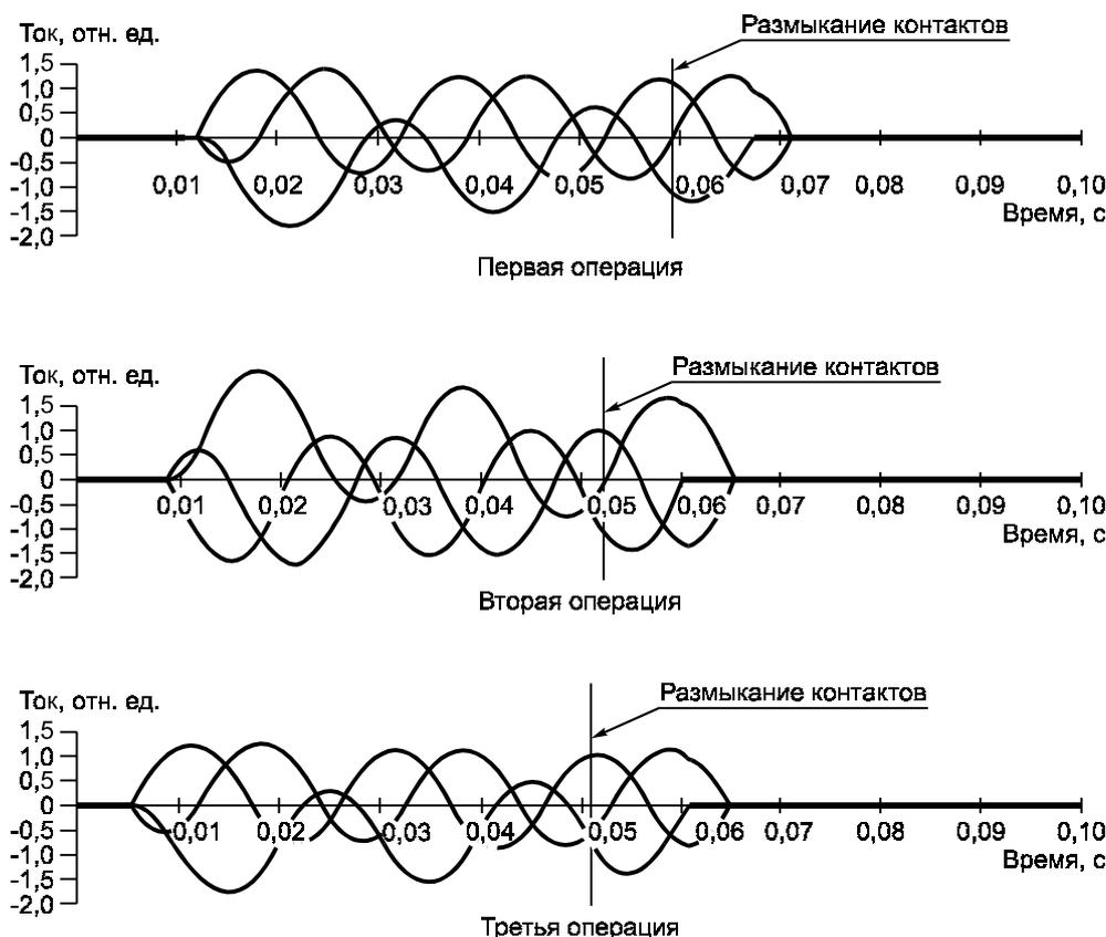
Рисунок 10 — Регулирование моментов иницирования тока и размыкания контактов относительно фазы тока при трехполюсном отключении тока в режиме Т100а
